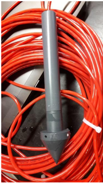
Foto 4.7: Opstelling met de drie waterspanningsmeters aan een zakbaak in proefvak D9 (Links) en een waterspanningsmeter voor plaatsing (rechts).
