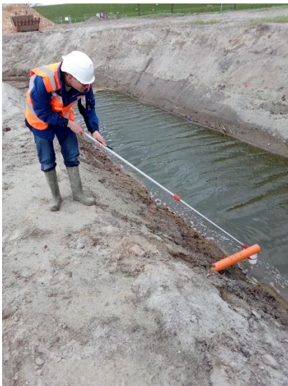
Foto 4.8: Monsternamen voor bepaling van de geleidbaarheid en debietmeting van de drainage in proefvak D9.
