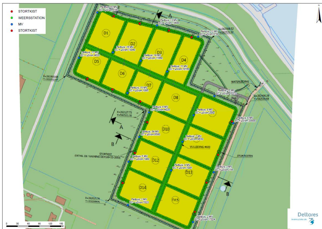
Figuur 4.32: Situering van de peilbuizen op de kleirijperij Delfzijl, en de geleidbaarheid op 11 november 2019.
